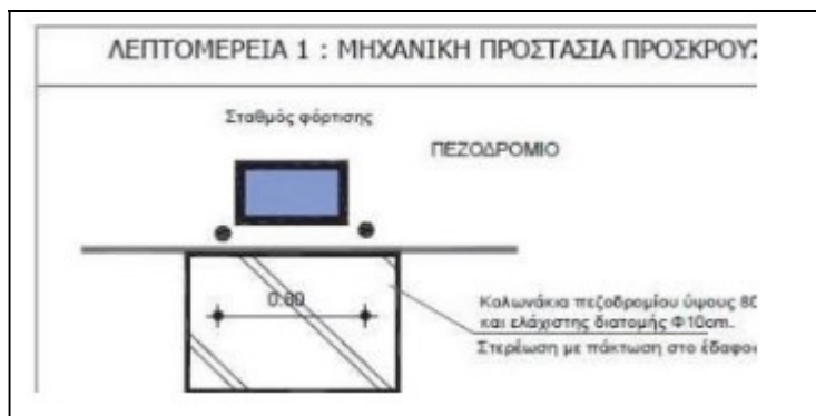
Λεπτομέρεια μηχανικής προστασίας.
